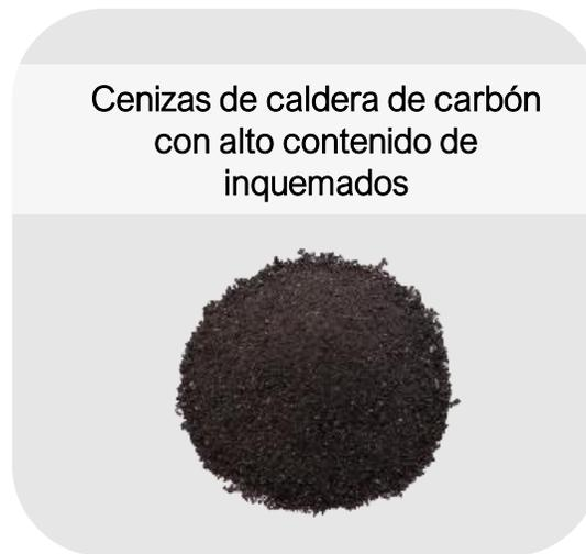
Cenizas de caldera de carbón con alto contenido de inquemados
