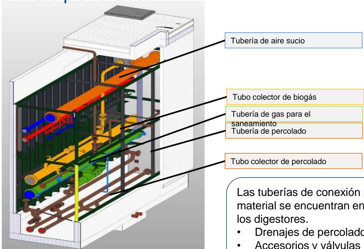
Las tuberías de conexión para todos los flujos de material se encuentran en la pared trasera detrás de los digestores.
